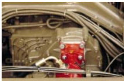
Das hydraulische Druckbegrenzungsventil ist entsprechend der Seilzugkraft eingestellt und plombiert. Es dient als Überlastsicherung.
